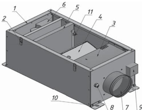
Поступающий наружный холодный воздух проходящий через воздушный клапан, фильтруется пылевым фильтром. Очищенный воздух всасывается через вентилятор, проходит через блок нагрева где подогревается до нужной температуры. Температура устанавливается на настенном пульте дистанционного управления поставляющимся в комплекте.
