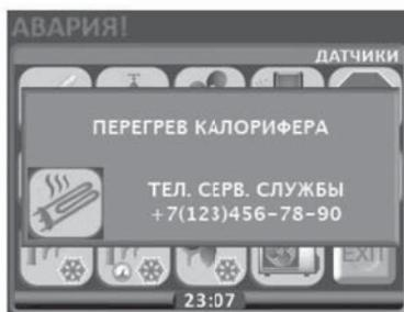
Запуск системы при наличии сигналов аварии невозможен, и каждый раз при нажатии кнопки ПУСК будет выводиться окно АВАРИЯ, до тех пор, пока активные аварии не будут сняты и сброшены.
